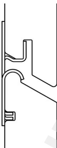
TIGA-Leisten können in beliebiger Breite und Stärke gefertigt werden. Die maximale Verformungskraft der Leisten darf die geprüften Grenzwerte der Verbinder nicht übersteigen - siehe Tabellen Auszugsprüfungen.
