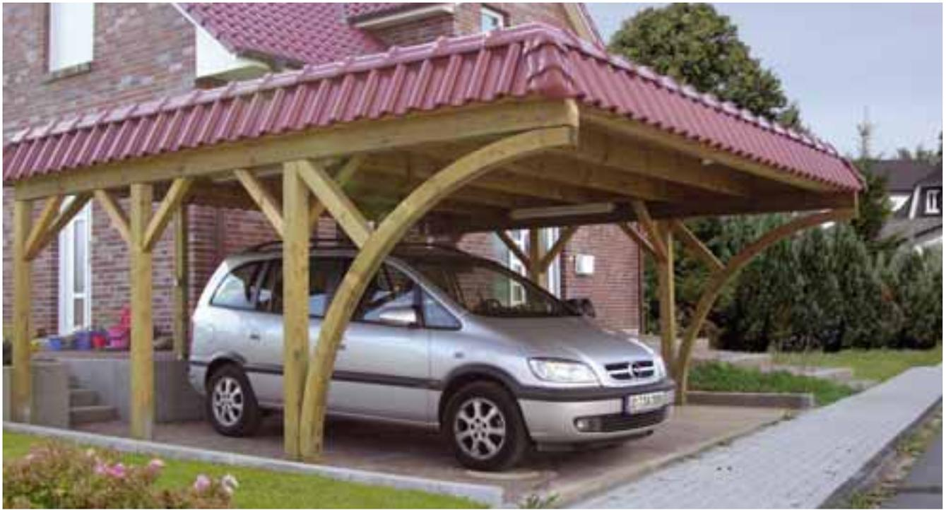
*Breite Einfahrt: Pfostenbogen aus Leimholz. Als bewährt praktische Alternative zum herkömmlichen Pfosten bei engen Einfahrtsituationen. Inkl. verstärkter Konstruktion/geänderter Pfostenabstände. Lieferbar für Standard-Durchfahrtshöhe von 210 cm. Rechenbeispiel s. Tabelle unten.*
