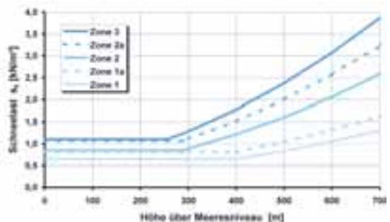
Charakteristischer Wert der Schneelast für Geländehöhe und Schneelastzone nach DIN 1055-5
