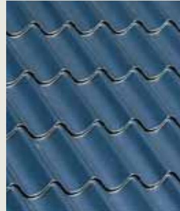
**3** Pfannenprofil-Eindeckung „Topline 40“: Stahlplatte im Ziegeldesign, leicht, widerstandsfähig, stabil. Für Dachneigungen ab 14°. In versch. Farben.
