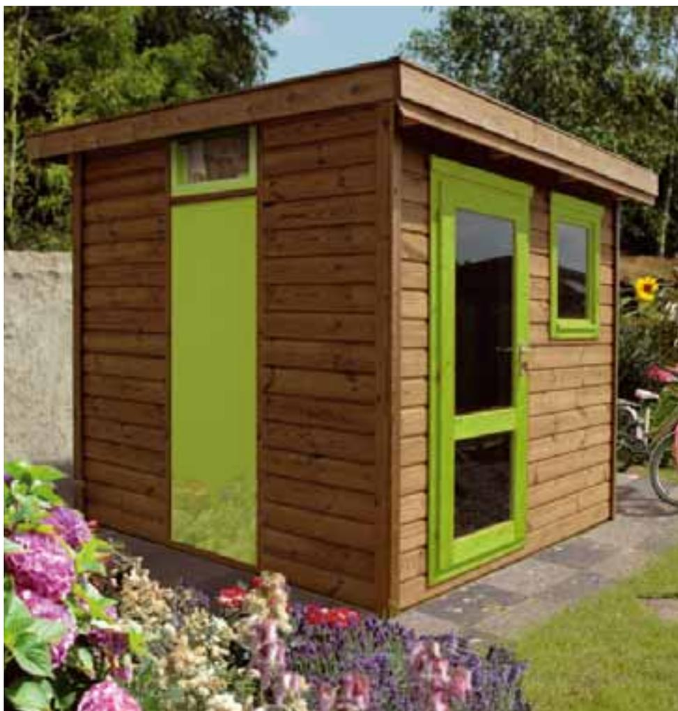
Lichtband und farbige Alu-Verbundplatten setzen den kontrastreichen Akzent, die Verkleidung erfolgt mit Stülp-Wechselfalz-Profilen. Gewußt wie: Die breite Dach-Blende verdeckt die Dachneigung.
