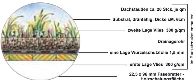
Der Begrünungsbausatz enthält. ca. 20 winterfeste Stauden pro m<sup>2</sup>. Das Substrat speichert das Wasser besonders gut und verhindert so das Austrocknen der Wurzelballen. Die Schutzvliese halten Substrat und Pflanzen bei Wind und Wetter auf Ihrem Dach. Die olivfarbene Wurzelenschutzbahn sorgt absolut zuverlässig dafür, dass die Wurzeln der massiven Dachkonstruktion keinen Schaden zufügen werden.
