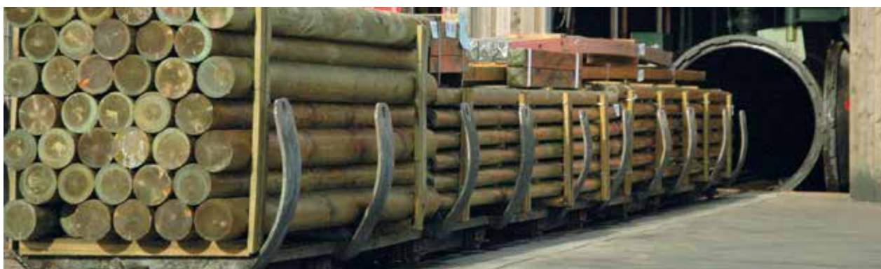
Loren mit Gartenholz – Beladen der Kesseldruckanlage
