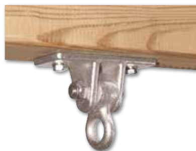
25 Schaukelhaken verzinkt, für Kugellager, mit Messinglager und Sicherheitsmutter zur Aufhängung an der Unterseite der Querstange. Schraubenlöcher Ø 13 mm, Öse für die Befestigung von Seilen oder Ketten mit Ø 20 mm. Gesamtmaß 130 x 50 x 100 mm.
