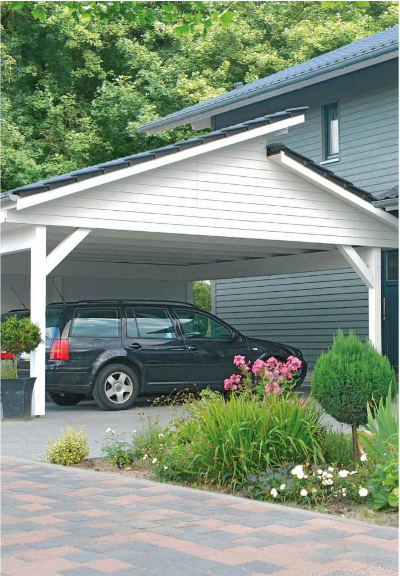
Bei dieser nach Kundenwunsch gearbeiteten Carport-Lösung folgt die Neigung des versetzten Pultdaches der Dachneigung des Wohngebäudes.
