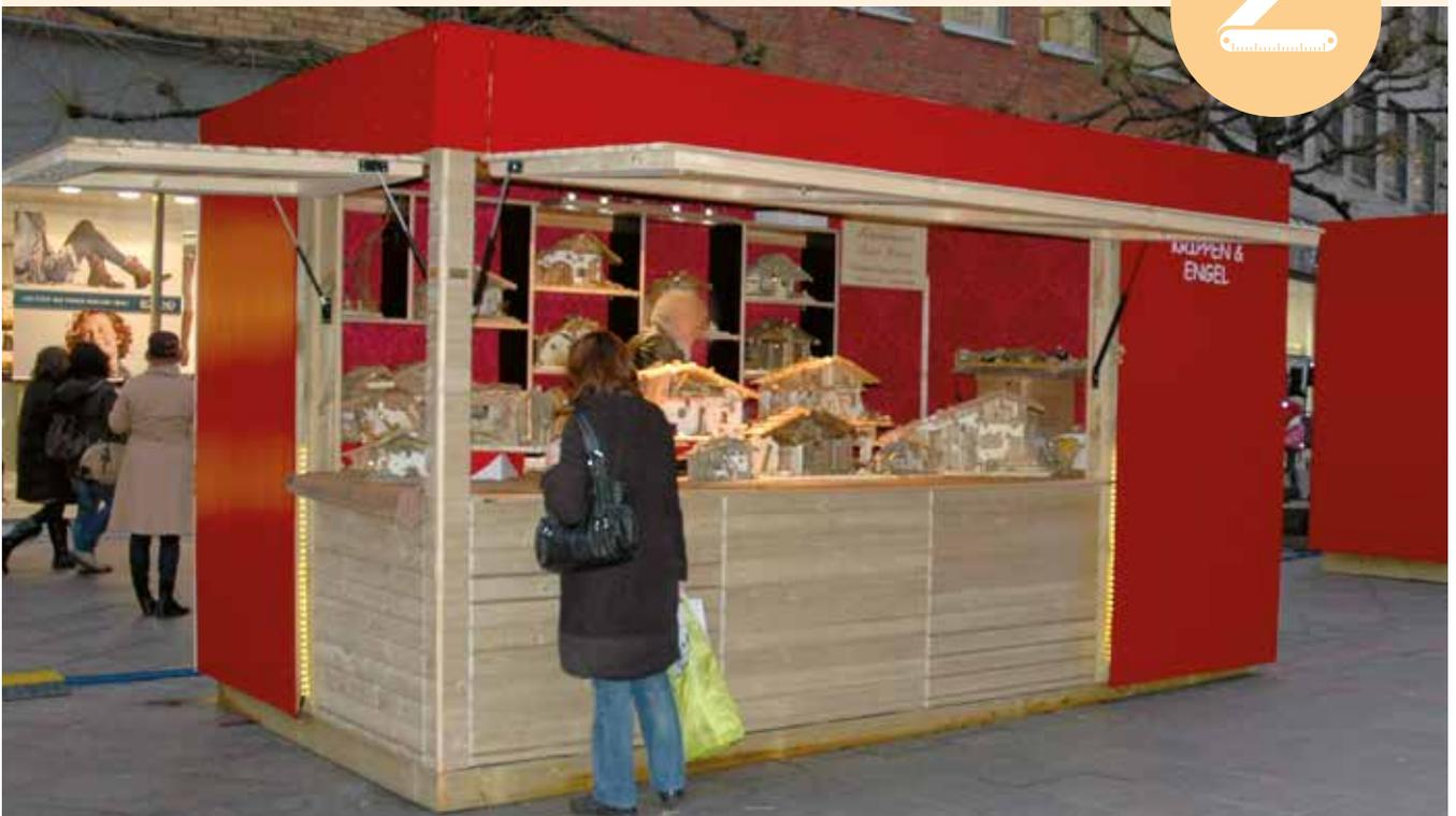
Individuelle Markthütte in Elementbauweise mit Fassadenplatten und Holzprofilen. Dach mit EPDM-Folie.
