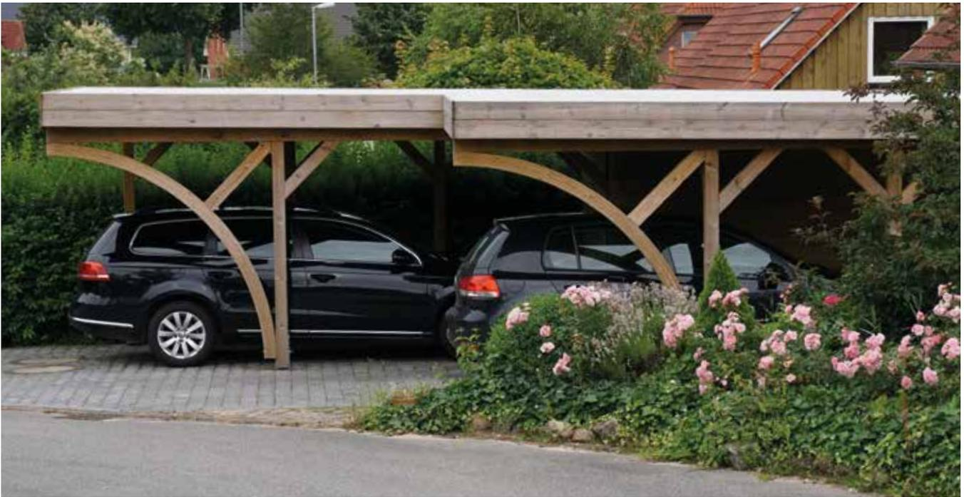
Als bewährt praktische Alternative zum herkömmlichen Pfosten bei engen Einfahrtsituationen. Pfostenbogen an einem Winkelcarport (Sondermodell). Inkl. verstärkter Konstruktion/geänderter Pfostenabstände. Lieferbar für Standard-Durchfahrthöhe von 210 cm. Rechenbeispiel s. Tabelle unten.
