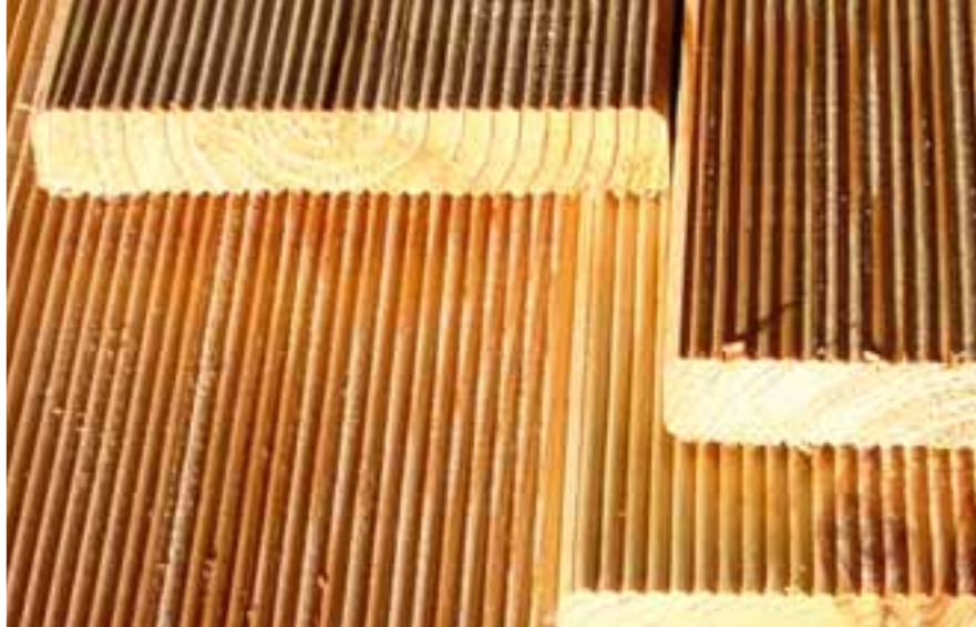
Kammergetrocknete Lärche. Detail: geriffelte Oberfläche
